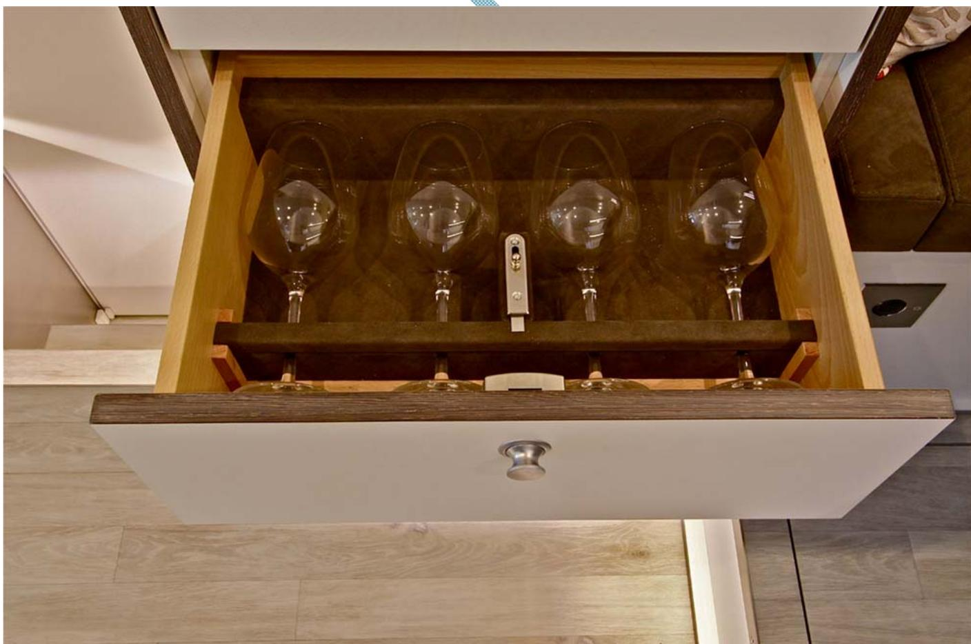
Eigengefertigter ACTION MOBIL-Kühlschrank mit optimaler Isolation, bequemen Auszügen, starker LED-Beleuchtung. Die Kompressorabwärme wird nach Aussen abgeführt.
