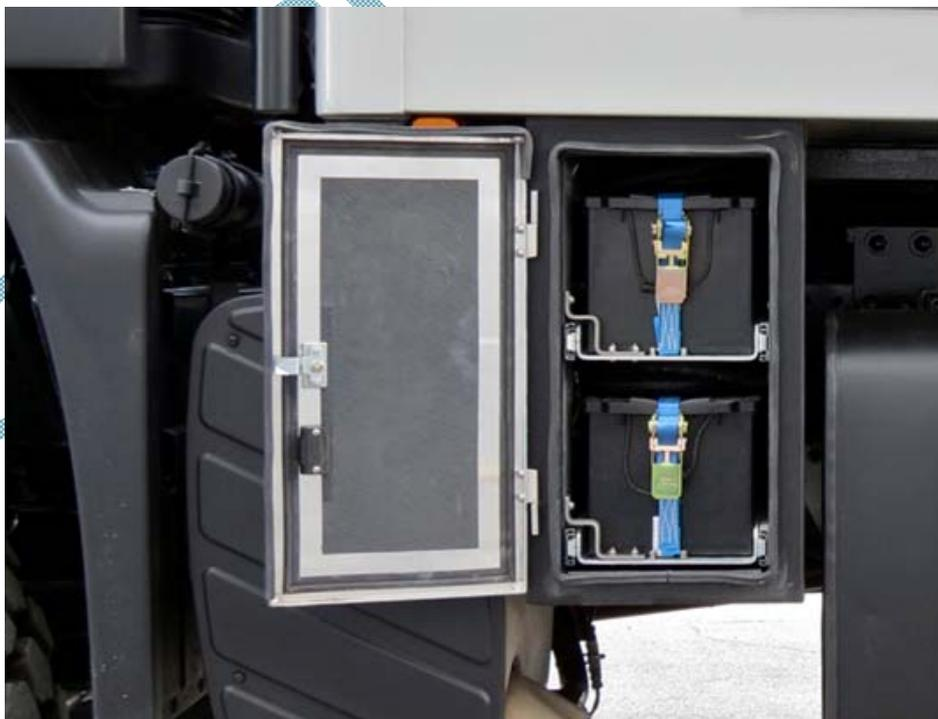
Zugangsklappe für Tank der Cassettentoilette: Eigengefertigte ACTION MOBIL-Stauklappe mit Sicherheits-Profilzylinder im Einschlüsselsystem:
