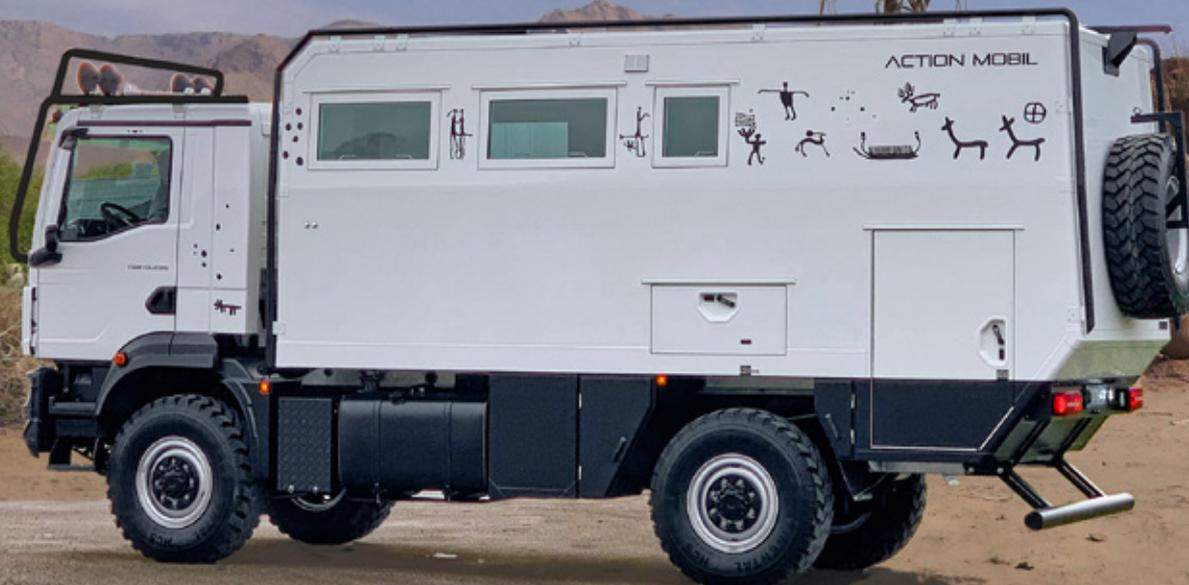
Der Wüsten-Kreuzfahrt-Cruiser von Actionmobil punktet mit einer kompakten Gesamtlänge von 7,64 Metern.
