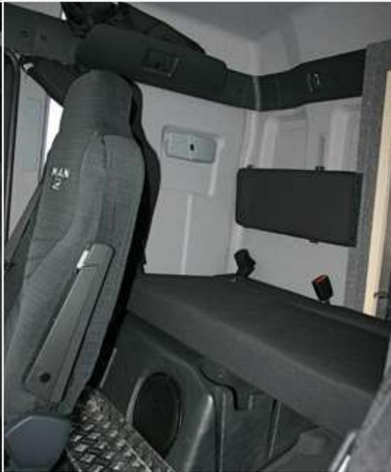
ACTION MOBIL permet le placement d'une banquette additionnelle dans la cabine du camion. Cette installation est composée d'un lit rabattable transformable en 4 sièges équipés de ceinture de sécurité.
