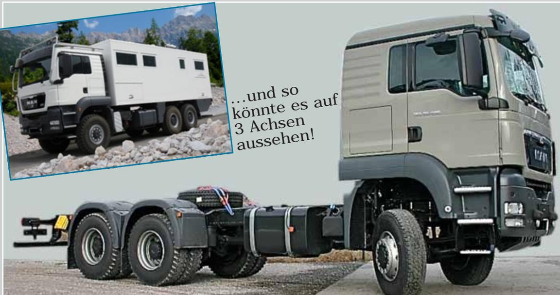
Die EURO 5 Motoren verfügen NICHT über eine Abgasrückführung. **Vorteil:** der zulässige Schwefelgehalt mit Treibstoff darf **50-fach höher sein** als bei Motoren mit Abgasrückführung. Zwar ist der Harnstoff "AdBlue" erforderlich, jedoch kann die **Harnstoffeinspritzung bei Einsatz außerhalb der EU abgeschaltet werden.**
