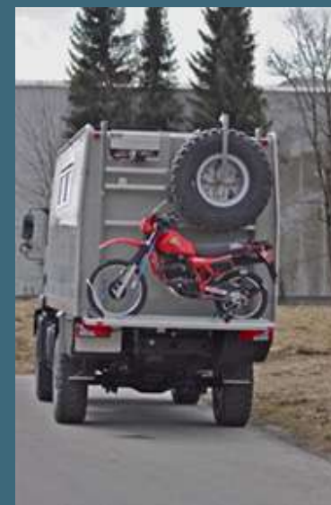
leicht und stabil: der elektrisch angetriebene Lift aus Edelstahl von ACTION MOBIL für Motorrad und Reserverad.
