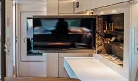
Écran plat escamotable installé sur la porte de l'armoire secrétaire. Parois lisse, sans poignées, sécurisée par un système central de fermeture.
